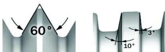
Профили пластин для обработки резьб API Round Vee и API Buttress
